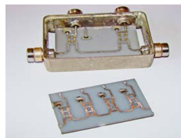
Рис. 3. Мікросмужкові схеми дво- та чотирьоканального ПМВЧ
